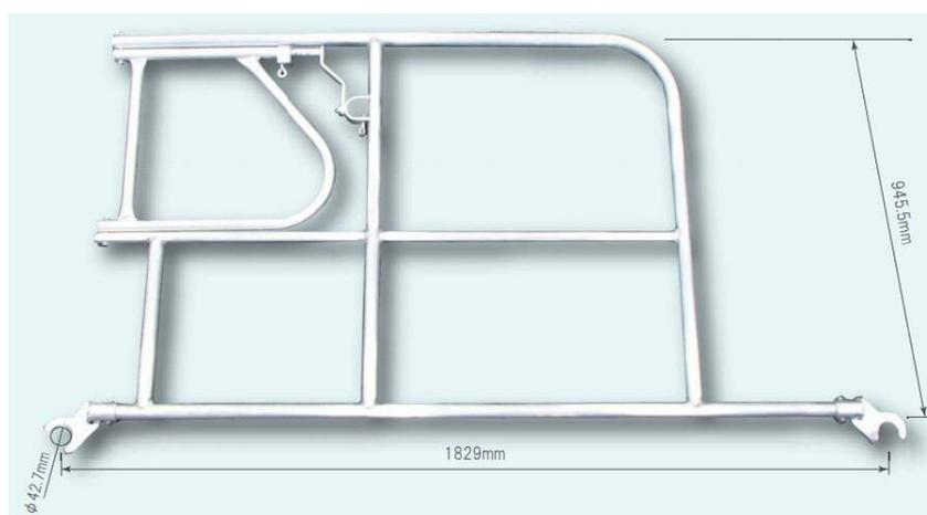
今回開発に成功したアルミ製階段手摺枠は、従来のスチール製階段手摺枠より40%の軽量化を実現いたしました。軽量化に伴い、特殊な支柱構造を用いることにより、仮設工業会の認定強度を満たすことができました。アルミ製の階段手摺枠は業界で初となります。
